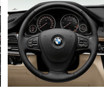
■ Çok işlevli düğmelere sahip deri direksiyon ; çok işlevli düğmelerle Cruise Control sistemini ve radyo ya da telefonu kumanda edebilirsiniz.
