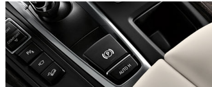
■ Otomatik tutuş fonksiyonuna sahip park freni orta konsol üzerindeki düğme aracılığıyla kolaylıkla etkinleştirilebilir. Gaz pedalına basıldığında fren serbest bırakılır. Otomatik tutuş fonksiyonu dur/kalk trafikte ya da yokuşta kalkış sırasında otomobil hareketsiz haldeyken geri ya da ileri doğru kaymasını engelleyerek sürücüye yardımcı olur.
