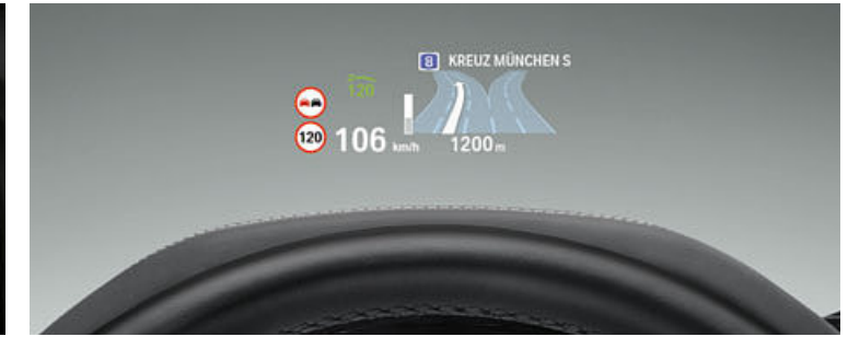
□ Tam renkli BMW Head-Up Display 3 sürüşle ilgili bilgileri doğrudan sürücünün görüş alanına yansıtır ve böylece sürücünün her zaman önündeki yola konsantre olmasını sağlar. Ekran; mevcut hız, navigasyon talimatları, ile telefon ve eğlence bilgilerini görüntüler.
