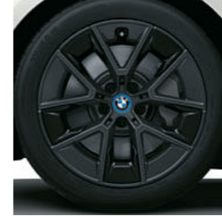
□ 18 inç, stil 854, Çok renkli, Koyu Gri, aerodinamik jantlar, karma lastiklerle, ön tekerleklerde 8.5J x 18 jant ve 245/45 R18 lastikler, arka tekerleklerde 9J x 18 jant ve 255/45 R18 lastikler. 1
