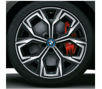
□ 19 inç, stil 860 M, Bicolor Siyah Gri, parlak işlenmiş M aerodinamik jantlar, karma lastiklerle, ön tekerleklerde 8.5J x 19 jant ve 245/40 R19 lastikler, arka tekerleklerde 9J x 19 jant ve 255/40 R19 lastikler. 2
