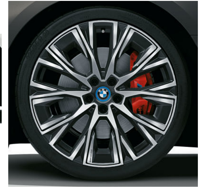
□ 20 inç, stil 862 l, Bicolor Siyah Gri, BMW Individual parlak işlenmiş aerodinamik jantlar, karma lastiklerle, ön tekerleklerde 8.5J x 20 jant ve 245/35 R20 lastikler, arka tekerleklerde 9J x 20 jant ve 255/35 R20 lastikler.
